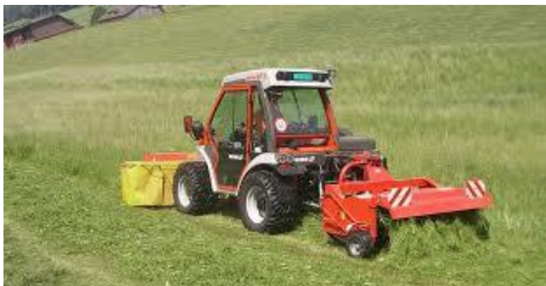
Figura 1 - Trattore specifica da montagna, o moto faucheuse à deux essieux con falciatrice frontale e condizionatrice posteriore. Le due funzioni sono separate per ripartire la massa sui singoli assi.
