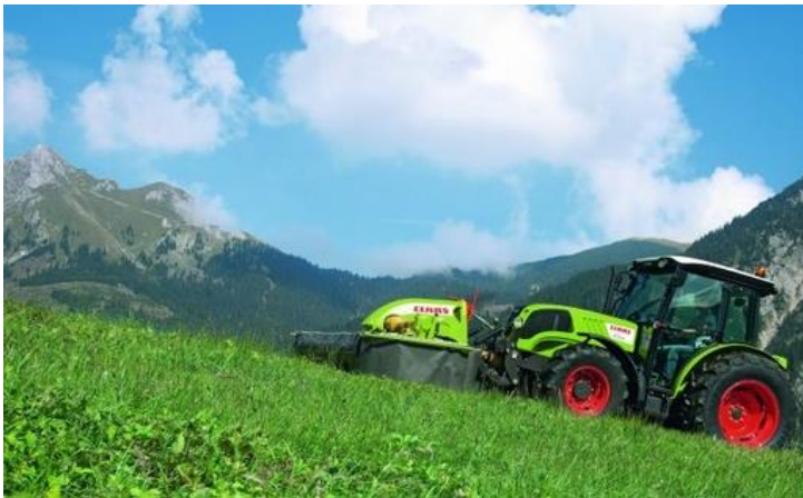
Figura 4 – trattoria convenzionale con operatrice accoppiata al sollevatore anteriore. E' evidente l'elevata distanza fra assale anteriore e gli organi di lavoro della falciatrice.
