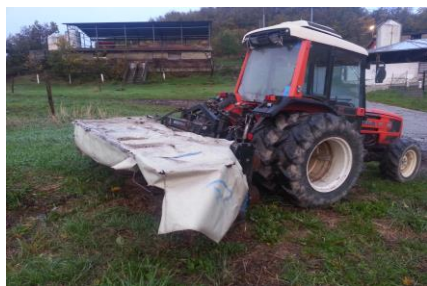
Figura 2 – A sn trattrice per ambienti montani derivata da una macchina convenzionale ricorrendo alla retroversione e alla gemellatura delle ruote; a ds trattrice con ruote isodiametriche in versione retroversa in fase di sfalcio
