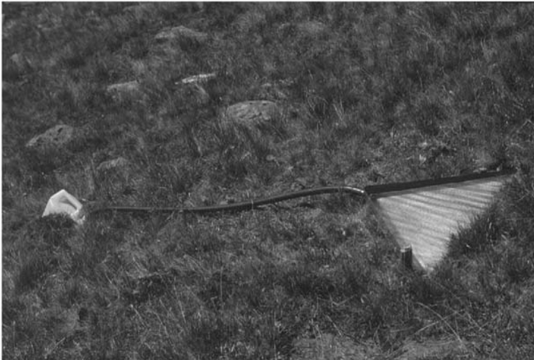
Figura 2 - Dispositivo tipo "Gerlach" posizionato sul pendio
