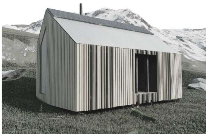
Figura 3 - Pianta e vista di un prototipo. Il rifugio è composto da due stanze per le attività diurne e notturne con uno spazio aperto al centro. Le aperture seguono il principio delle porte rivolte verso lo spazio aperto e delle finestre verso i bordi, suggerendo una relazione pertinente tra pieni, vuoti, struttura e sistemi di involucro. La pensilina è concepita come un elemento unico assemblato in fabbrica e trasportato in loco. I supporti telescopici servono ad adattarsi alle irregolarità del terreno. Studenti: Mustafa Banzaroglu, Federico Camillini, Luca Panzeri, Emanuel V. Jicmon. Workshop "Upwards!" - I edizione.
