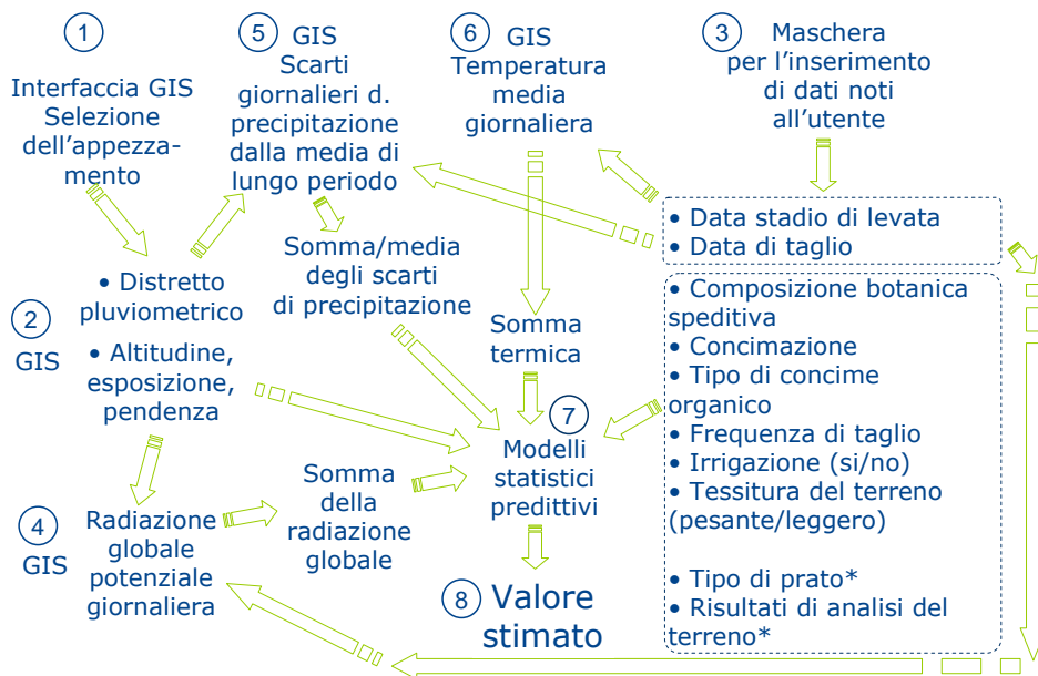
Figura 2 – Diagramma di flusso dell'applicazione web. Solamente i passi 1 e 3 richiedono l'inserimento di informazioni da parte dell'utente. * Informazioni facoltative da parte dell'utente.
