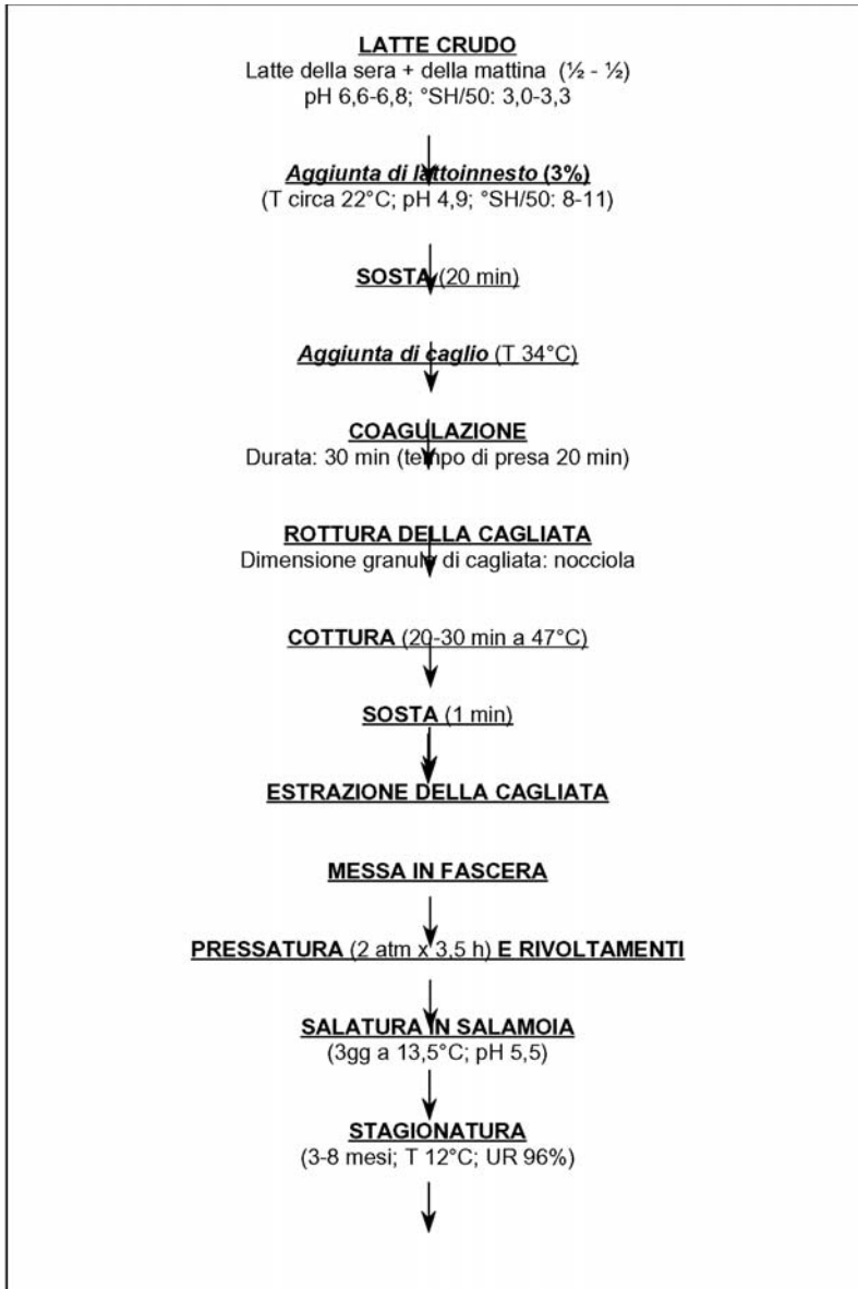
Figura 1: Tecnologia di lavorazione sperimentale del formaggio (tipo Nostrano di Primiero) prodotto in malga.
