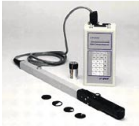
Fig. 19 - Il Plant Canopy Analyzer ha consentito di misurare la superficie fogliare
