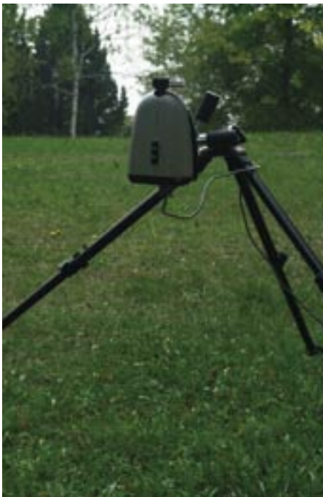
Fig. 18 - Lo spettroradiometro ha consentito di stimare la produttività e il contenuto di azoto della vegetazione
