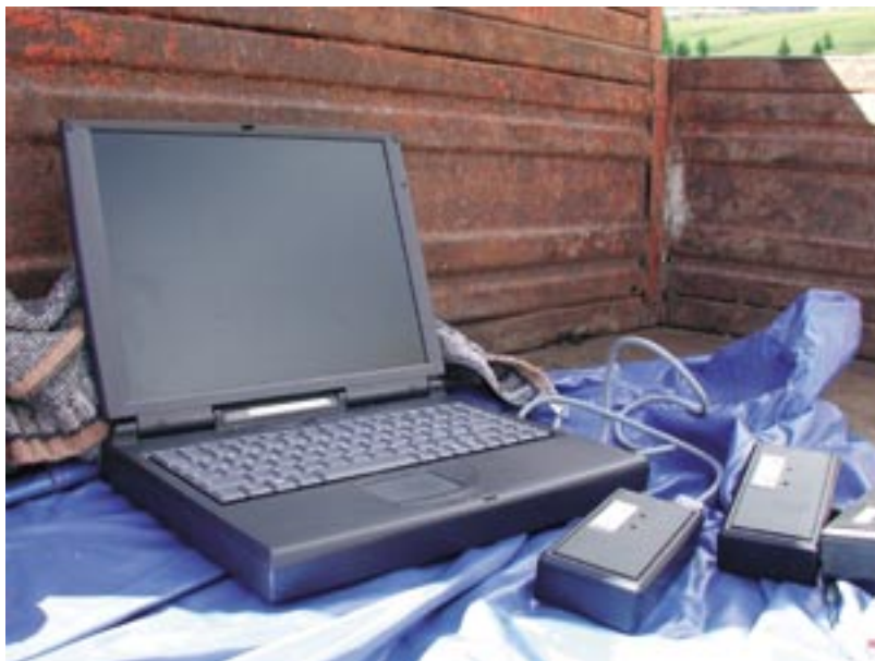
Fig. 22 - I dati rilevati con i masticometri vengono scaricati su PC portatile al momento della mungitura e successivamente elaborati
