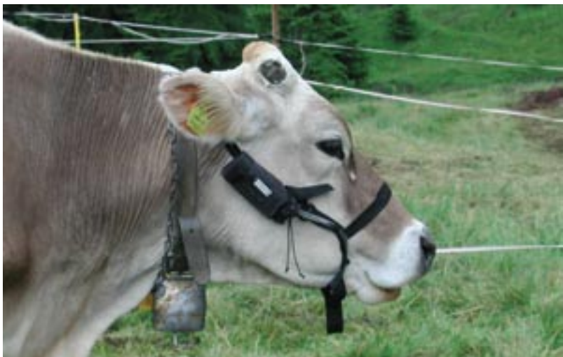
Fig. 21 - Masticometro utilizzato per la valutazione dei tempi di masticazione e ruminazione delle bovine al pascolo
